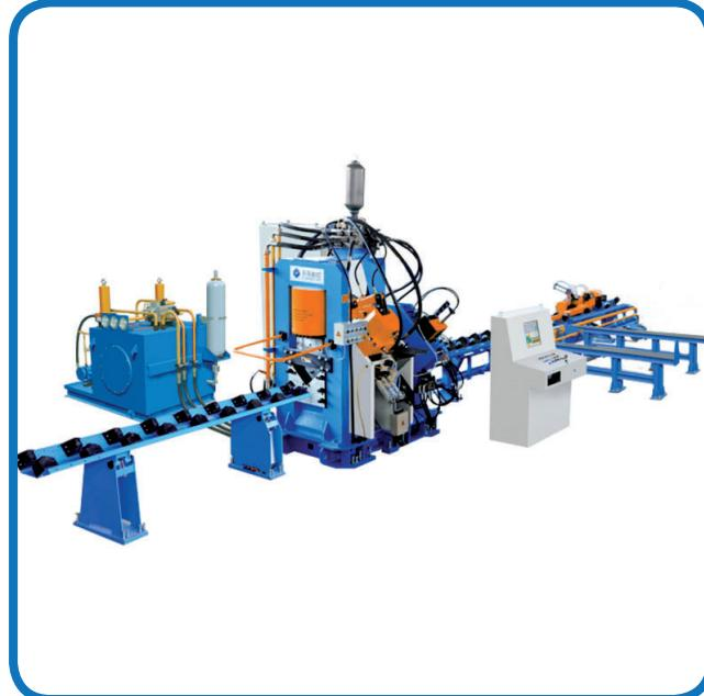
Модуль пробивки позволяет использовать на каждой стороне одновременно до 3-х пuhanсонов различного размера. Как и в модуле сверления, здесь есть возможность их быстрой замены. Для резки углового проката применяется нож с двойным лезвием, приводимый в движение гидроцилиндром.
